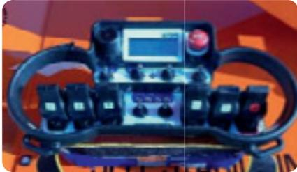
Übersichtliche Kabelfernbedienung (optional Funkfernbedienung) und geräumiges Ablagefach
